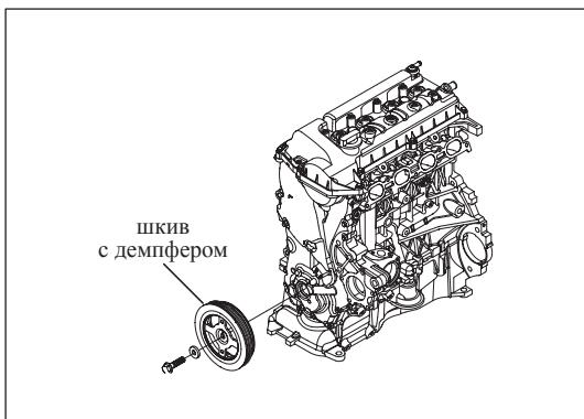
Рис. 13-3-24. Установка шкива с демпфером
