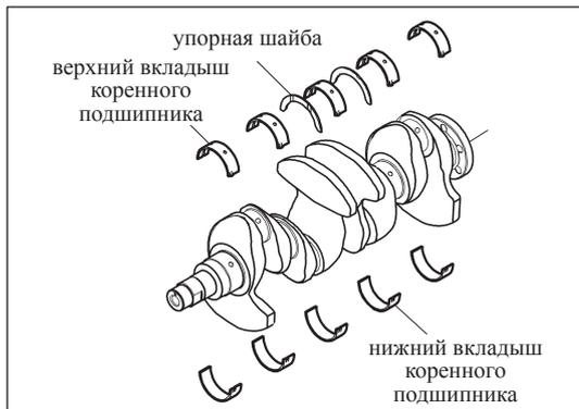
Рис. 13-3-7. Проверка коленчатого вала и вкладышей коренных подшипников
