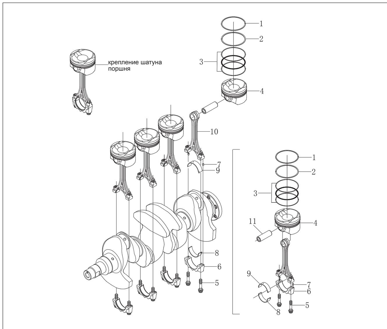
Рис. 13-2-1. Схема крепления компонентов шатуна поршня
