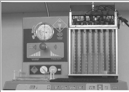
Рис. 9-1-6. Прибор для анализа и прочистки топливных форсунок
