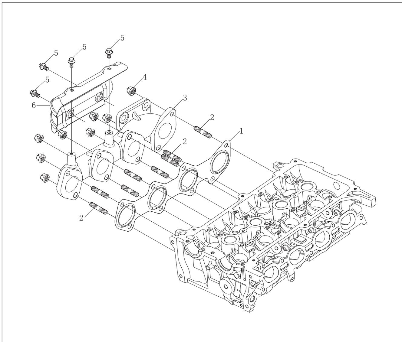
Рис. 8-3-1. Схема расположения компонентов системы выпуска отработавших газов
