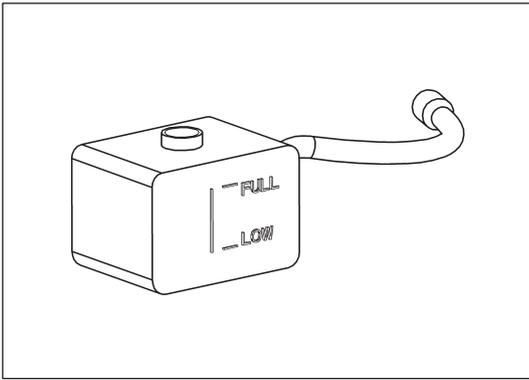
Рис. 10-2-1. Проверка охлаждающей жидкости в расширительном бачке
