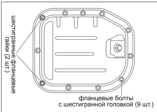
Рис. 11-3-3. Снятие масляного поддона
