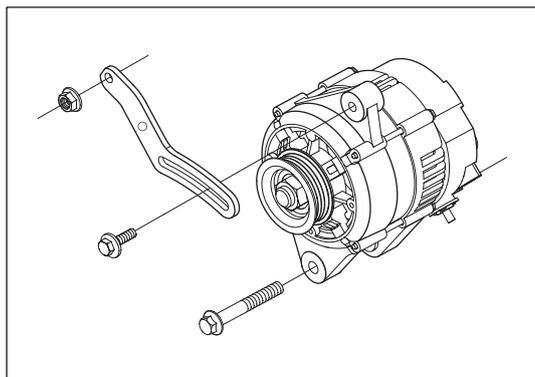
Рис. 6-2-1. Разборка крепления генератора
