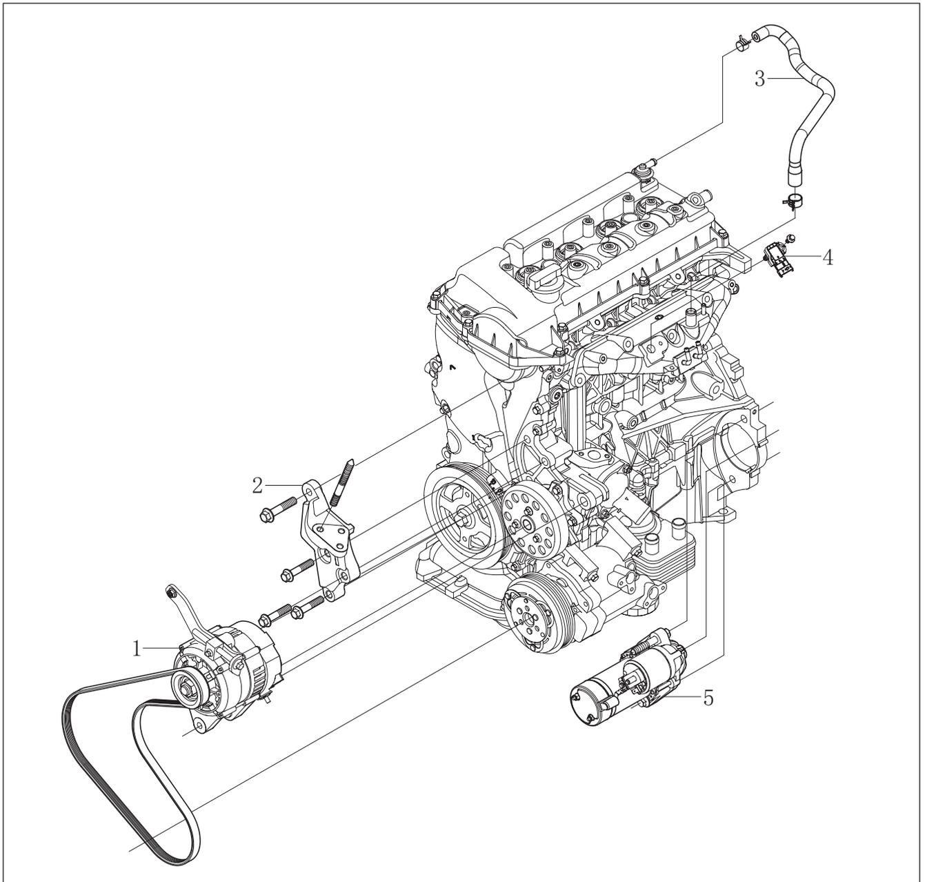
Рис. 6-1-1. Схема сборки внешних компонентов двигателя
