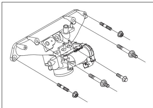
Рис. 8-2-7. Установка впускного коллектора (4G15B)
