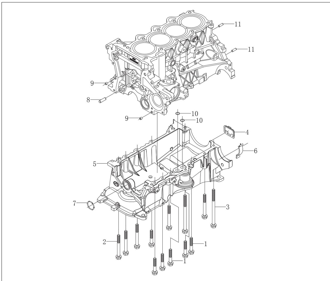
Рис. 13-4-1. Схема расположения компонентов верхней и нижней частей блока цилиндров бензинового двигателя
