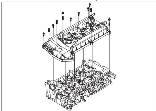
Рис. 12-2-7. Установка крышки головки блока цилиндров
