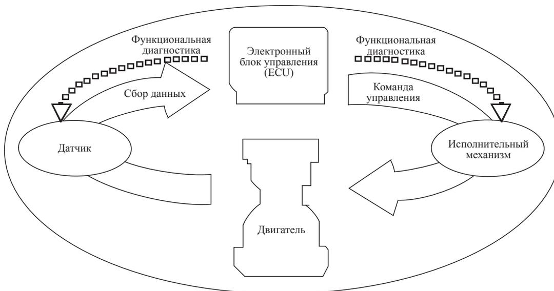
Рисунок 9-3-1. Принципиальная схема электронной системы впрыска топлива
