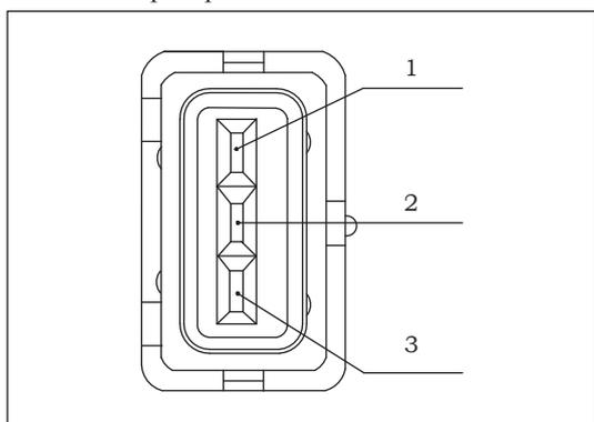
Рисунок 9-3-9. Контакты датчика положения
