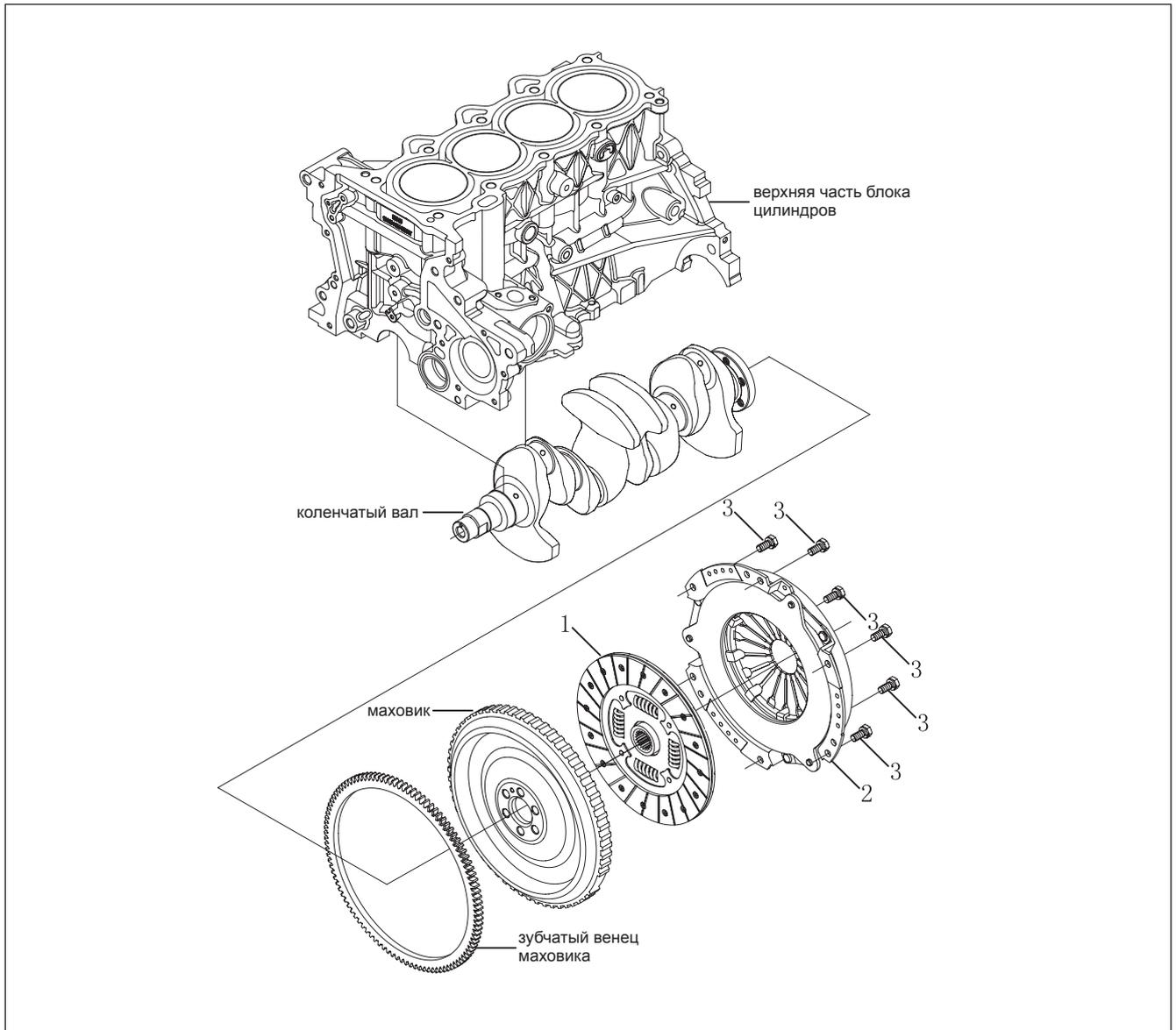
Рис. 14-1-1. Схема расположения компонентов сцепления
