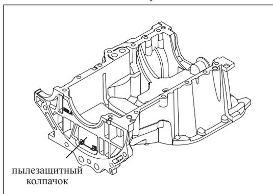
Рис. 13-4-8. Установка пылезащитного колпачка нижней части блока цилиндров
