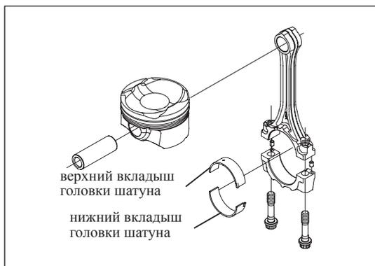
Рис. 13-2-12. Установка шатунов и вкладышей
