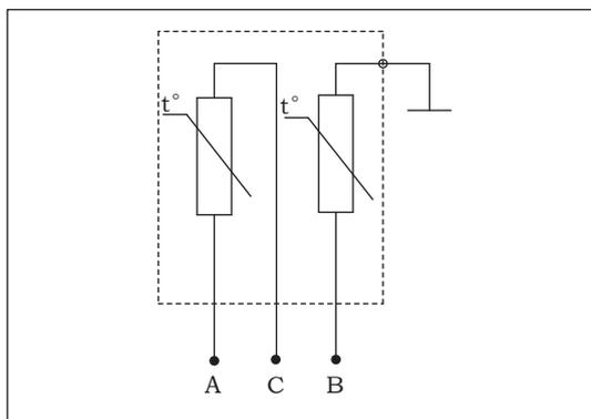
Рис. 9-3-17. Схема датчика температуры ОЖ
