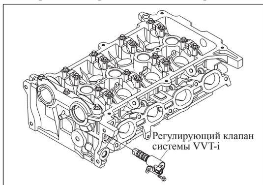
Рис. 12-3-49. Установка регулирующего клапана системы VVT-i
