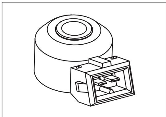
Рис. 9-3-14. Датчик детонации
