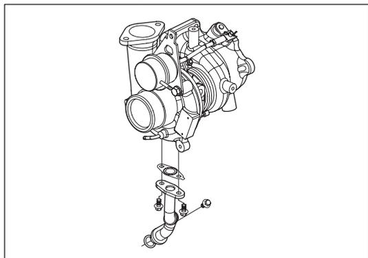
Рис. 7-2-4. Установка отводящей масляной трубки турбонагнетателя
