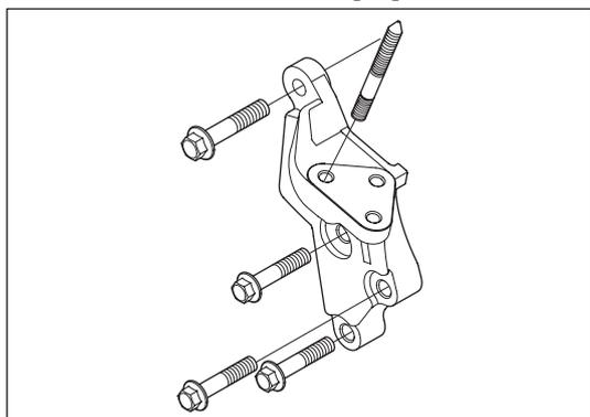
Рис. 6-4-4. Установка передней опоры двигателя
