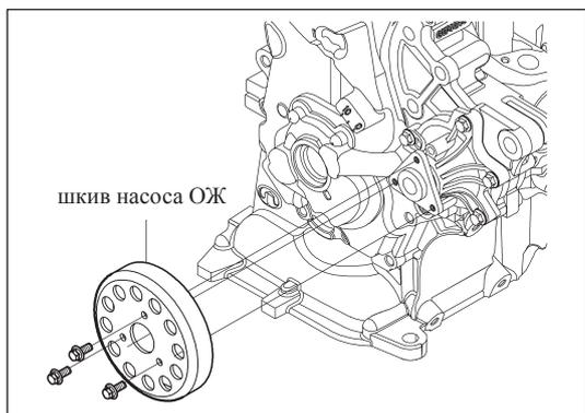
Рис. 10-4-9. Установка шкива насоса ОЖ
