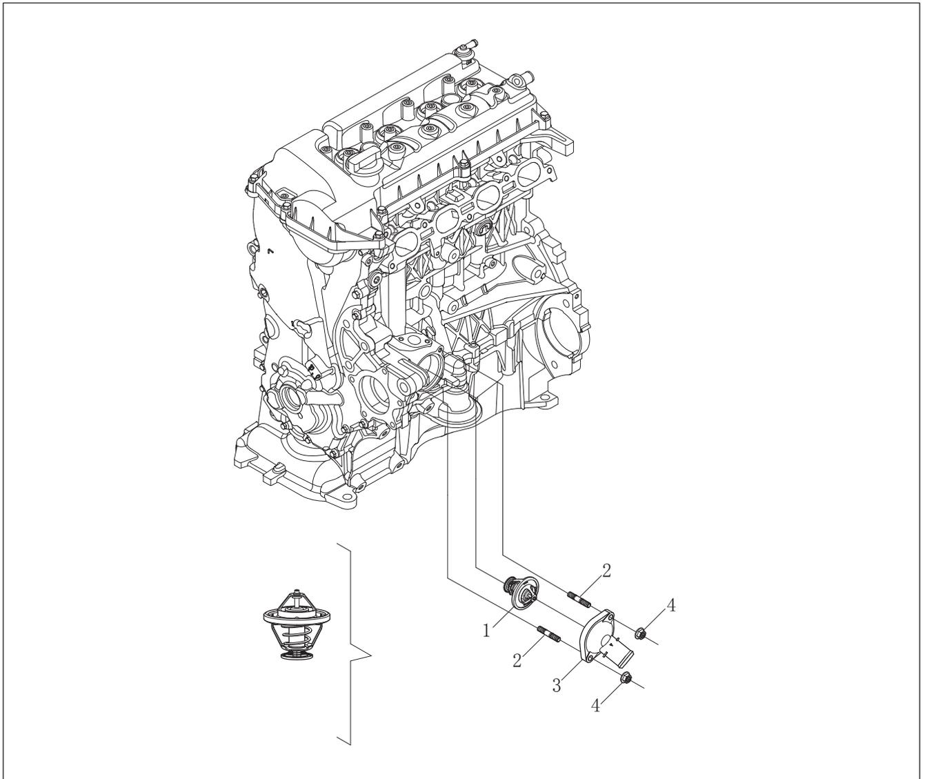
Рис. 10-5-1. Схема расположения компонентов термостата
