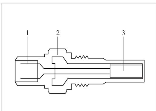
Рис. 9-3-18. Датчик температуры ОЖ в разрезе
