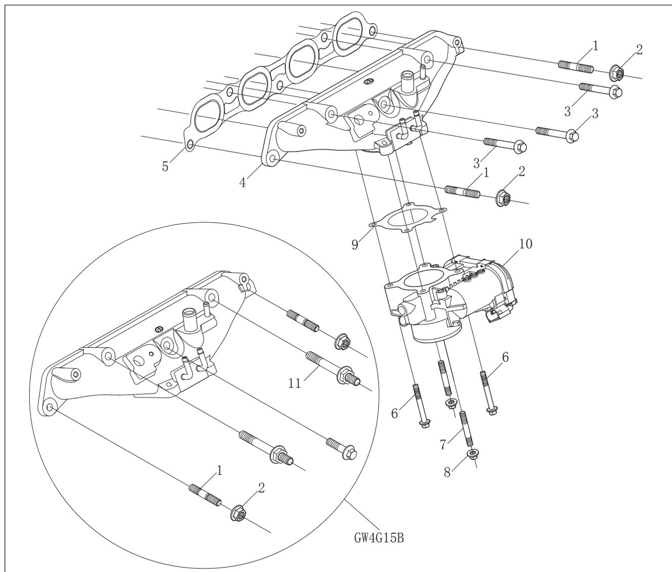
Рис. 8-2-1. Схема расположения компонентов системы подачи воздуха
