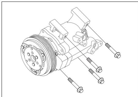
Рис. 6-4-2. Снятие компрессора кондиционера
