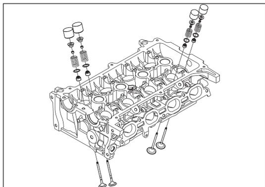
Рис. 12-3-38. Установка толкателя клапана
