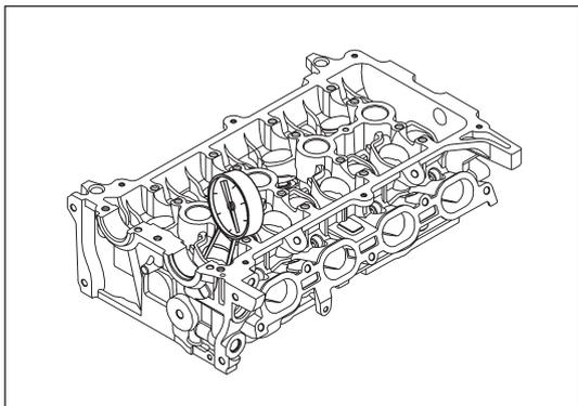
Рис. 12-3-33. Измерение внутреннего диаметра отверстия для установки направляющей втулки клапана
