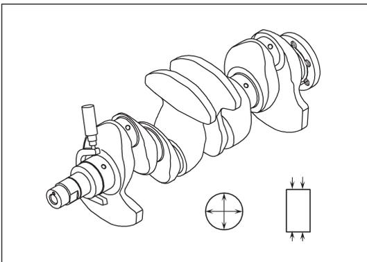
Рис. 13-3-12. Измерение диаметра шейки коленчатого вала
