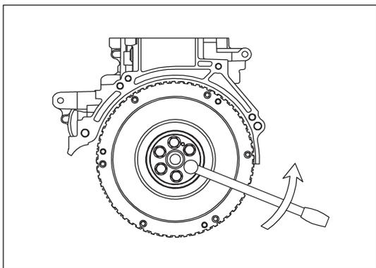
Рис. 13-3-2. Снятие болта маховика
