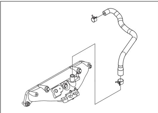
Рис. 6-4-6. Установка шланга системы принудительной вентиляции картера
