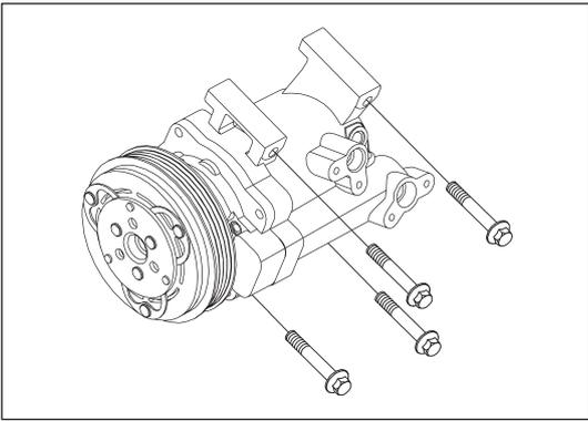
Рис. 6-4-5. Установка компрессора кондиционера
