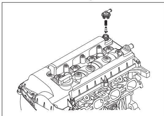
Рис. 12-2-8. Установка системы принудительной вентиляции картера
