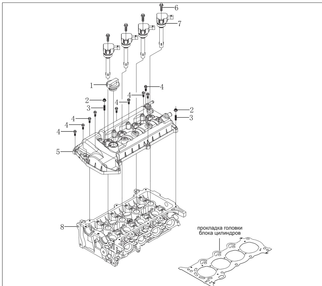
Рис. 12-2-1. Схема расположения компонентов крышки головки блока цилиндров
