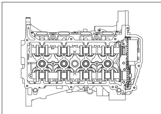
Рис. 12-2-6. Нанесение герметика в месте соединения крышки ГРМ и крышки головки блока цилиндров
