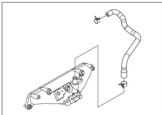
Рис. 6-4-3. Снятие шланга принудительной вентиляции картера
