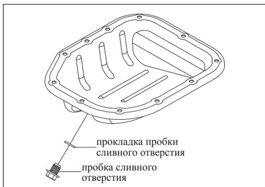
Рис. 11-2-5. Снятие и установка пробки для слива масла из масляного поддона
