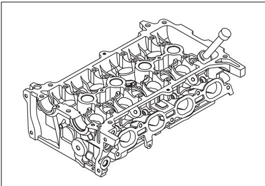
Рис. 12-3-5 Снятие сухарей клапанов
