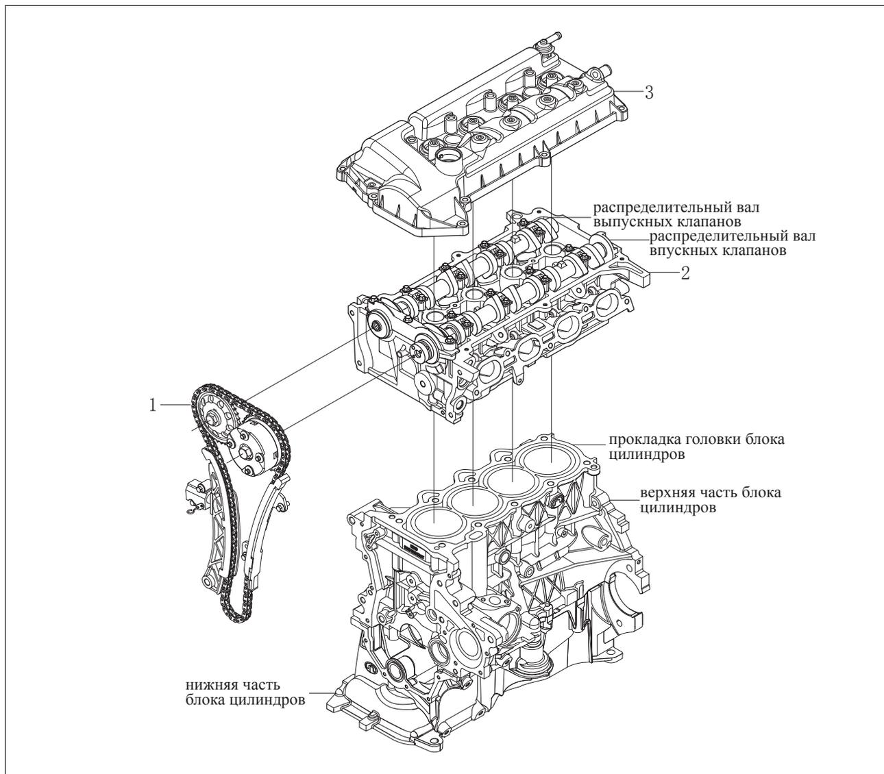
Рис. 12-1-1. Схема расположения компонентов головки блока цилиндров и ГРМ
