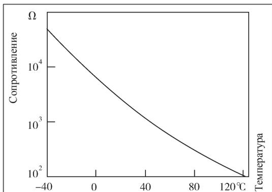
Рис. 9-3-19. Характеристическая кривая датчика температуры ОЖ
