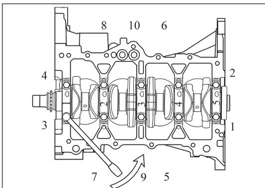
Рис. 13-3-4. Порядок снятия болтов коренных подшипников
