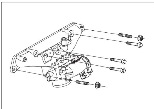
Рис. 8-2-2. Снятие впускного коллектора (4G15T)
