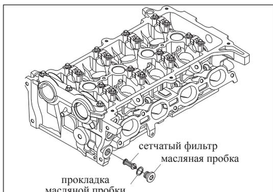
Рис. 12-3-48. Установка сетчатого фильтра, прокладки пробки и масляной пробки
