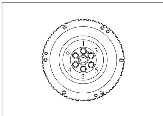
Рис. 13-3-23. Симметричное затягивание болтов маховика
