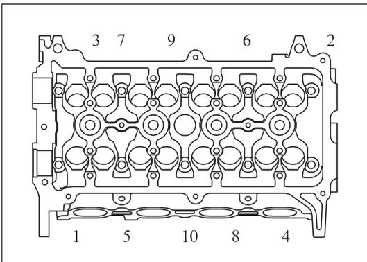
Рис. 12-3-4 Очередность снятия болтов головки блока цилиндров
