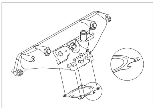
Рис. 8-2-8. Установка прокладки дроссельной заслонки
