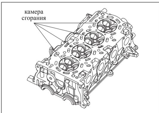
Рис. 12-3-8. Удаление нагара из камеры сгорания
