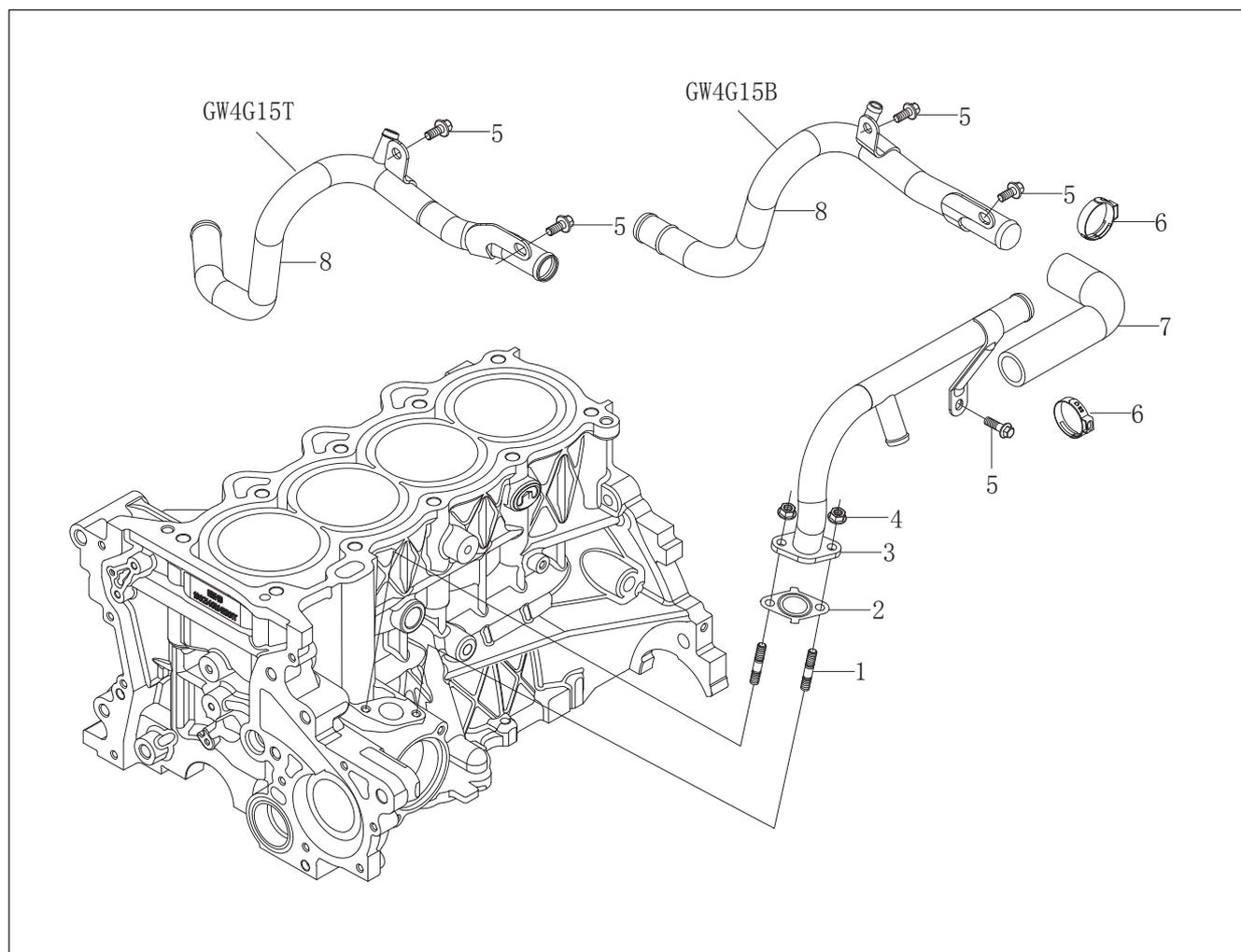
Рис.10-6-1. Сборочная схема деталей отводящей трубы нагретой ОЖ
