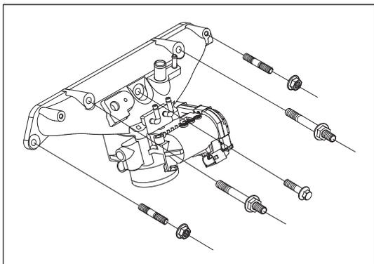
Рис. 8-2-3. Снятие впускного коллектора (4G15B)
