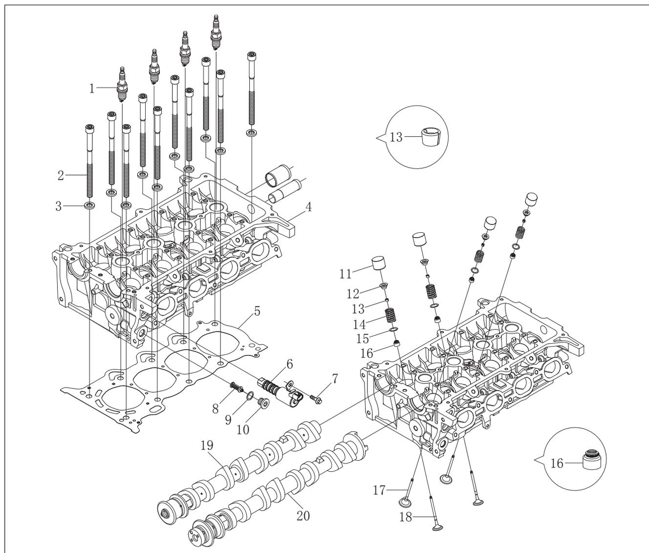
Рис. 12-3-1. Схема монтажа компонентов головки блока цилиндров и механизма привода клапанов
