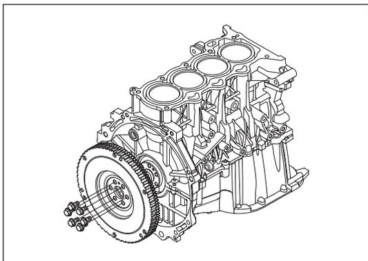
Рис. 13-3-3. Снятие маховика
