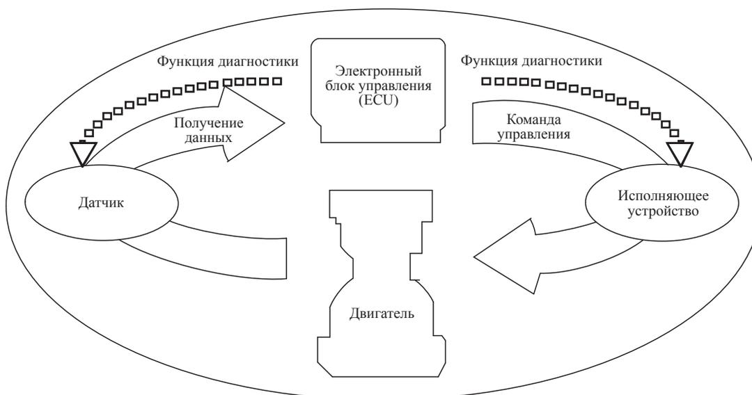
Рис. 9-2-1. Принцип обнаружения неисправностей электронной системы впрыска топлива
