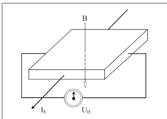
Рисунок 9-3-10. Принципиальная схема работы датчика Холла
