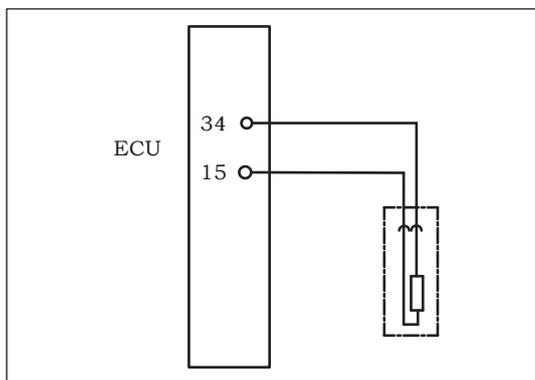
Рисунок 9-3-13. Схема датчика частоты вращения коленчатого вала
