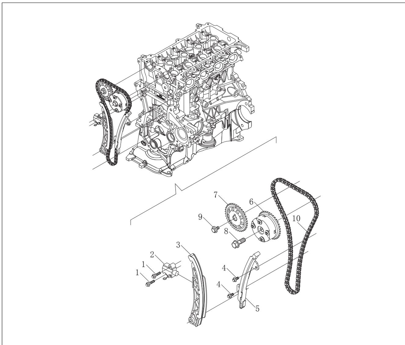
Рис. 12-4-1 Схема расположения компонентов газораспределительного механизма (ГРМ)
