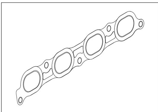
Рис. 8-2-5. Прокладка впускного коллектора
