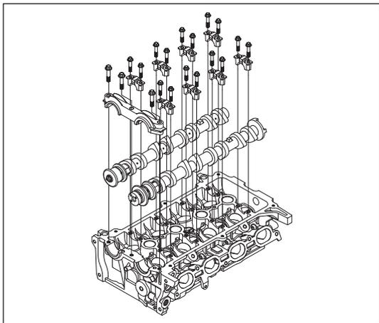
Рис. 12-3-43. Установка распределительных валов впускных и выпускных клапанов
