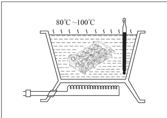
Рис. 12-3-32. Нагрев головки цилиндров
