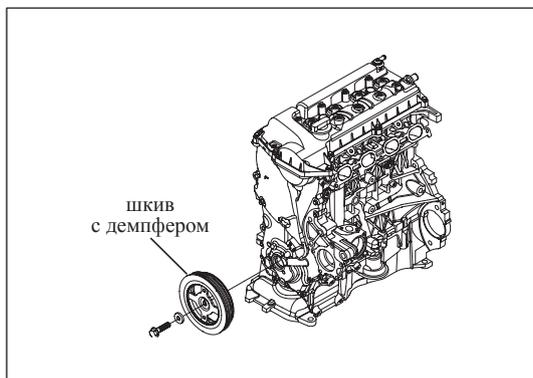
Рис. 13-3-24. Установка шкива с демпфером
