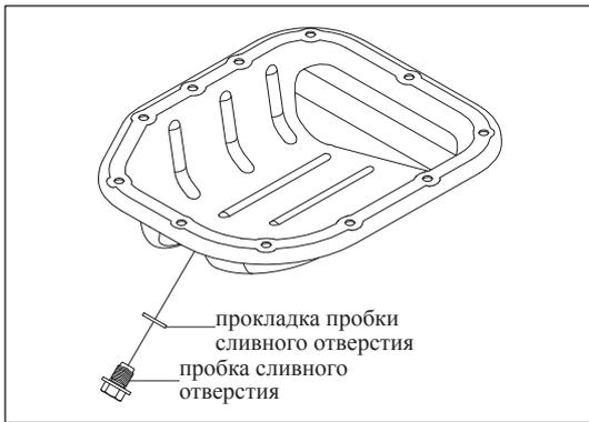
Рис. 11-3-2. Слив масла из системы смазки двигателя
