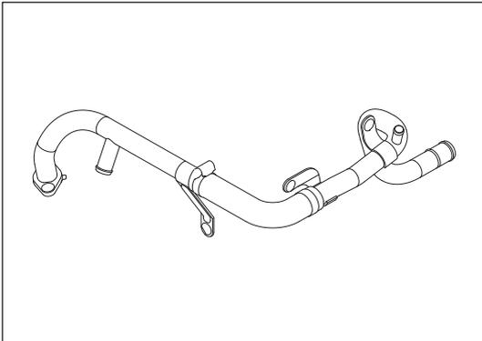
Рис. 10-6-4. Проверка отводящей трубы нагретой ОЖ
