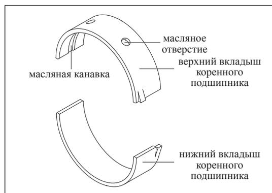
Рис. 13-3-17. Верхний и нижний вкладыши коренного подшипника
