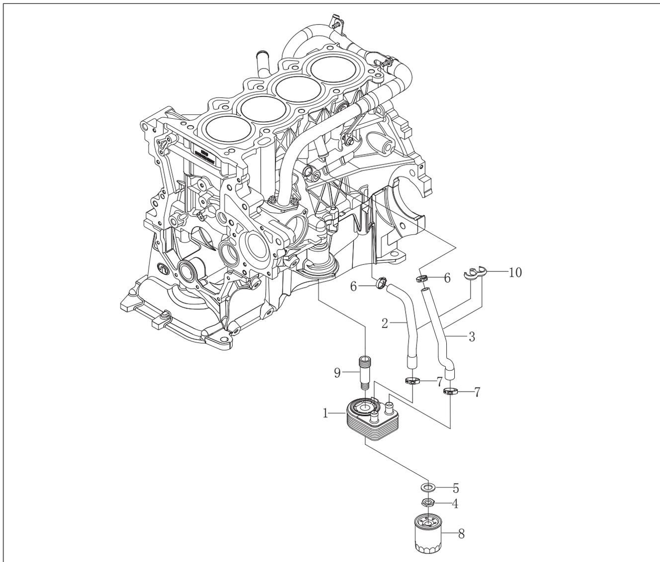
Рис. 10-3-1. Схема расположения деталей масляного радиатора
