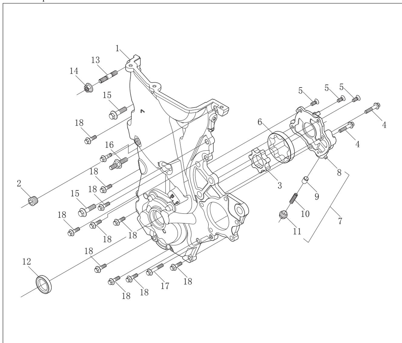
Рис. 11-4-1. Схема компонентов масляного насоса
