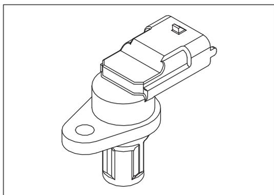
Рисунок 9-3-8. Датчик положения распределительного вала
