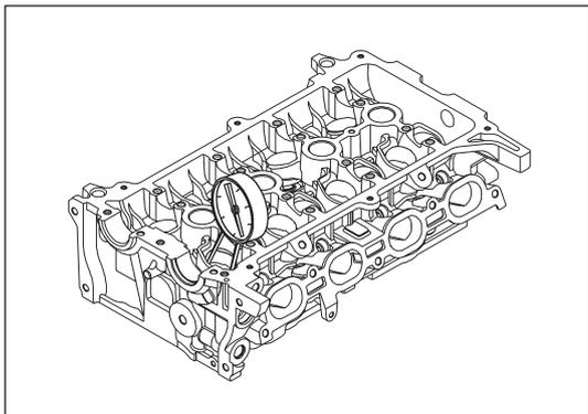
Рис. 12-3-30. Измерение диаметра отверстия в головке блока цилиндров для толкателя клапана
