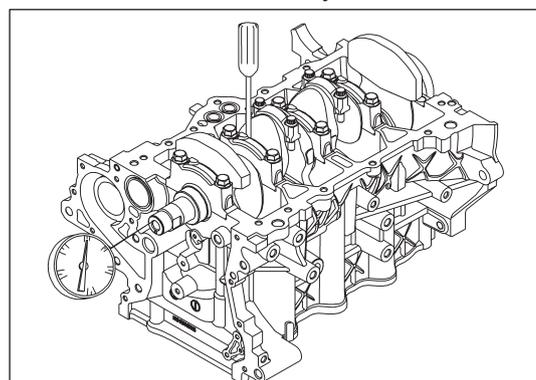
Рис. 13-3-16. Измерение осевого зазора коленчатого вала
