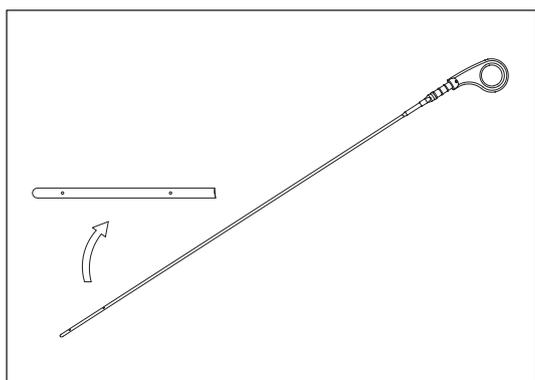
Рис. 11-2-2. Проверка уровня масла с помощью маслоизмерительного щупа
