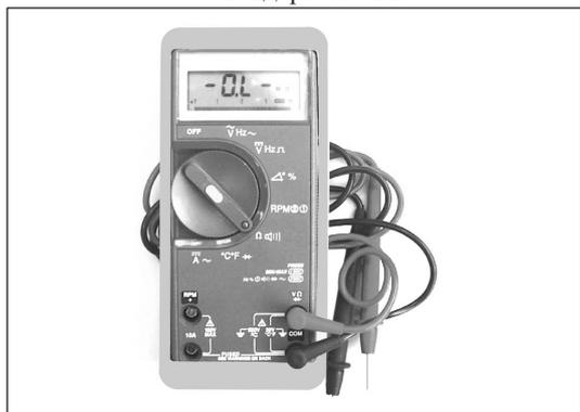
Рис. 9-1-2. Цифровой мультиметр
