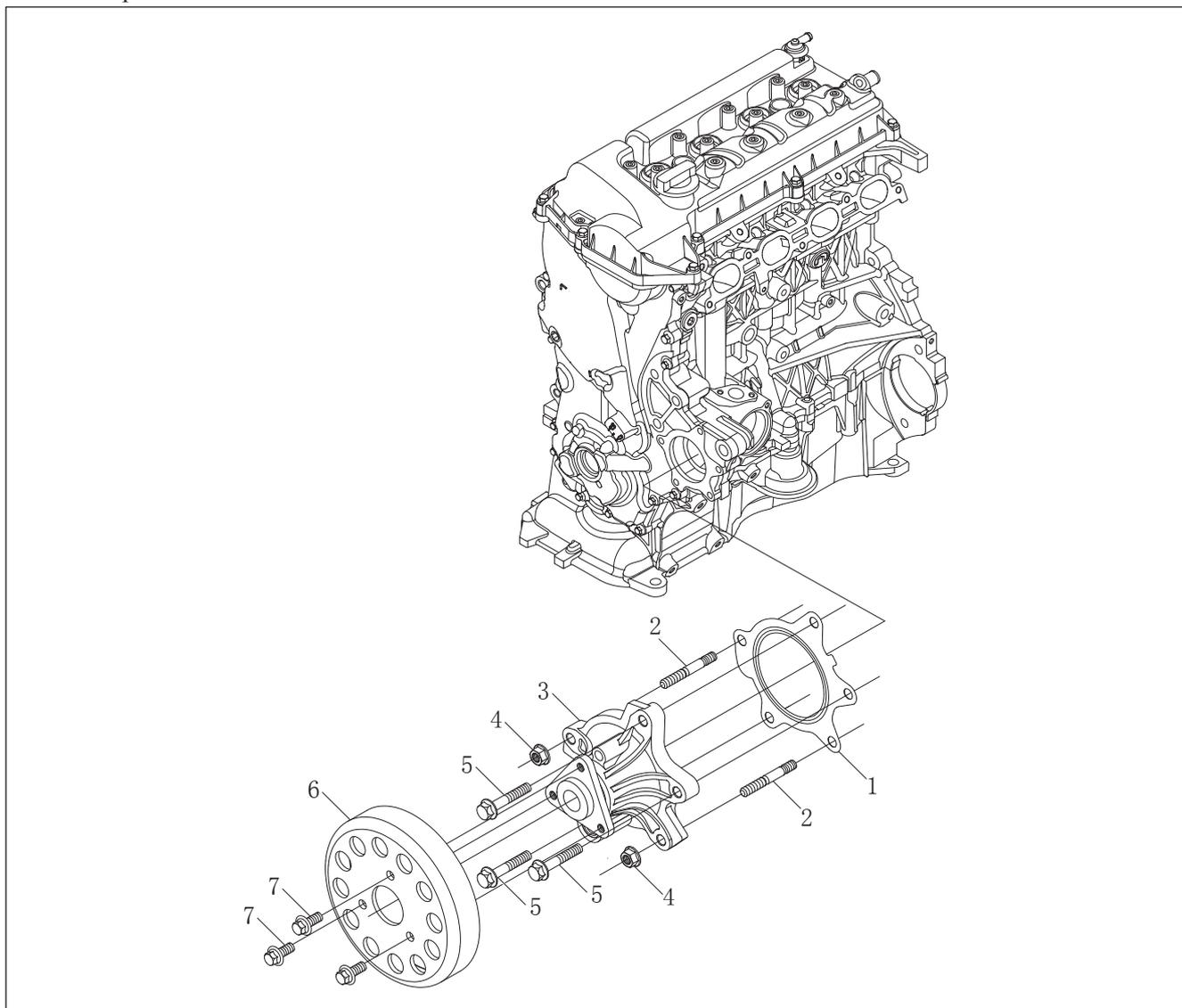
Рис. 10-4-1. Схема расположения компонентов насоса охлаждающей жидкости (ОЖ) бензинового двигателя
