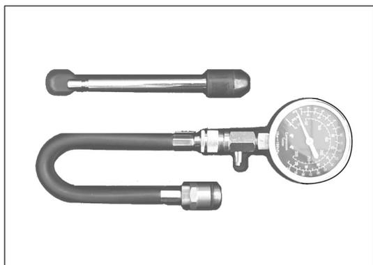
Рис. 9-1-3. Прибор для измерения давления в цилиндрах
