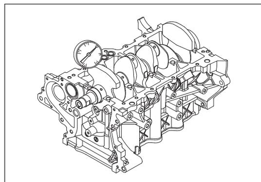
Рис. 13-3-15. Измерение осевого зазора большой головки шатуна
