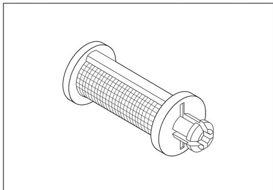
Рис. 12-3-47. Проверка сетчатого фильтра
