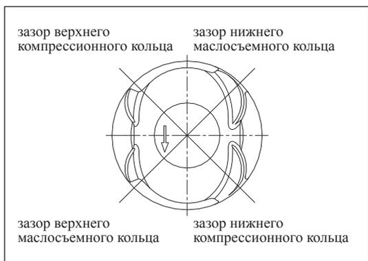
Рис. 13-2-11. Положение зазора поршневых колец
