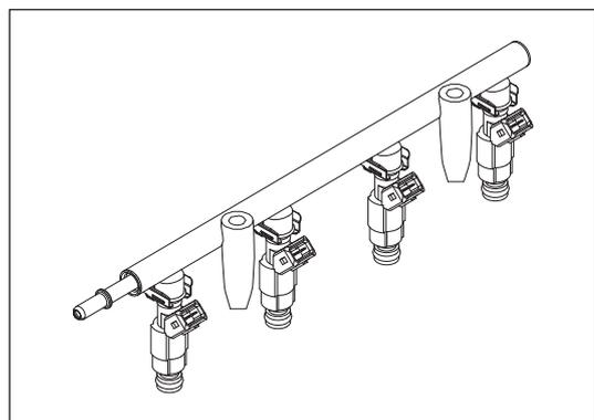
Рисунок 9-3-4. Топливная рампа
