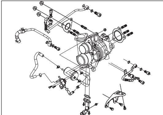
Рис. 7-2-2. Снятие компонентов турбоагнетателя
