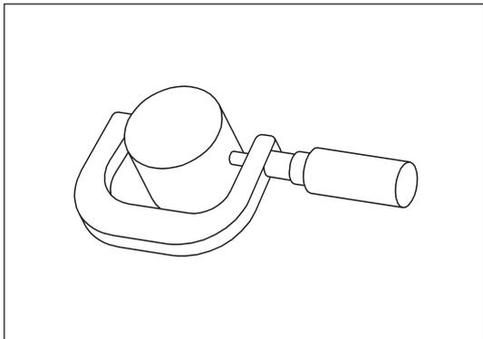
Рис. 12-3-31. Измерение диаметра толкателя клапана
