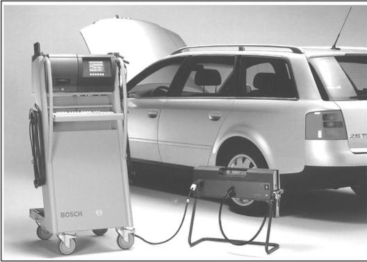
Рис. 9-1-5. Анализатор отработавших газов
