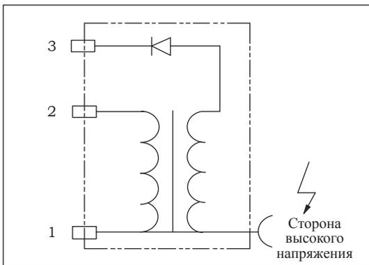
Рис. 9-3-25. Электрическая схема катушки зажигания
