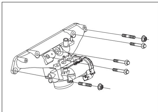
Рис. 8-2-6. Установка впускного коллектора (4G15T)
