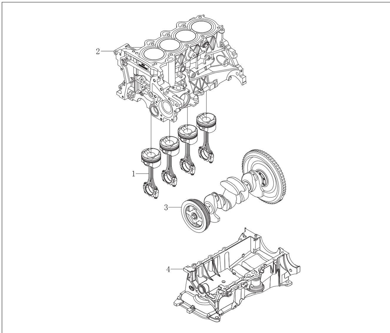
Рис. 13-1-1. Схема расположения компонентов блока цилиндров
