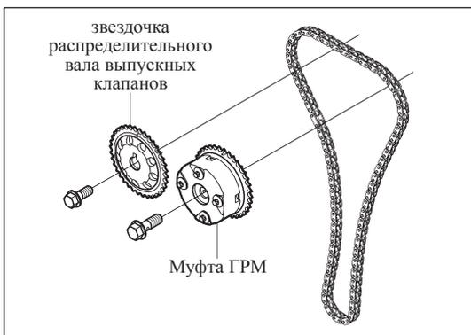
Рис. 12-4-9. Установка звездочки распределительного вала выпускных клапанов и муфты системы VVT-i
