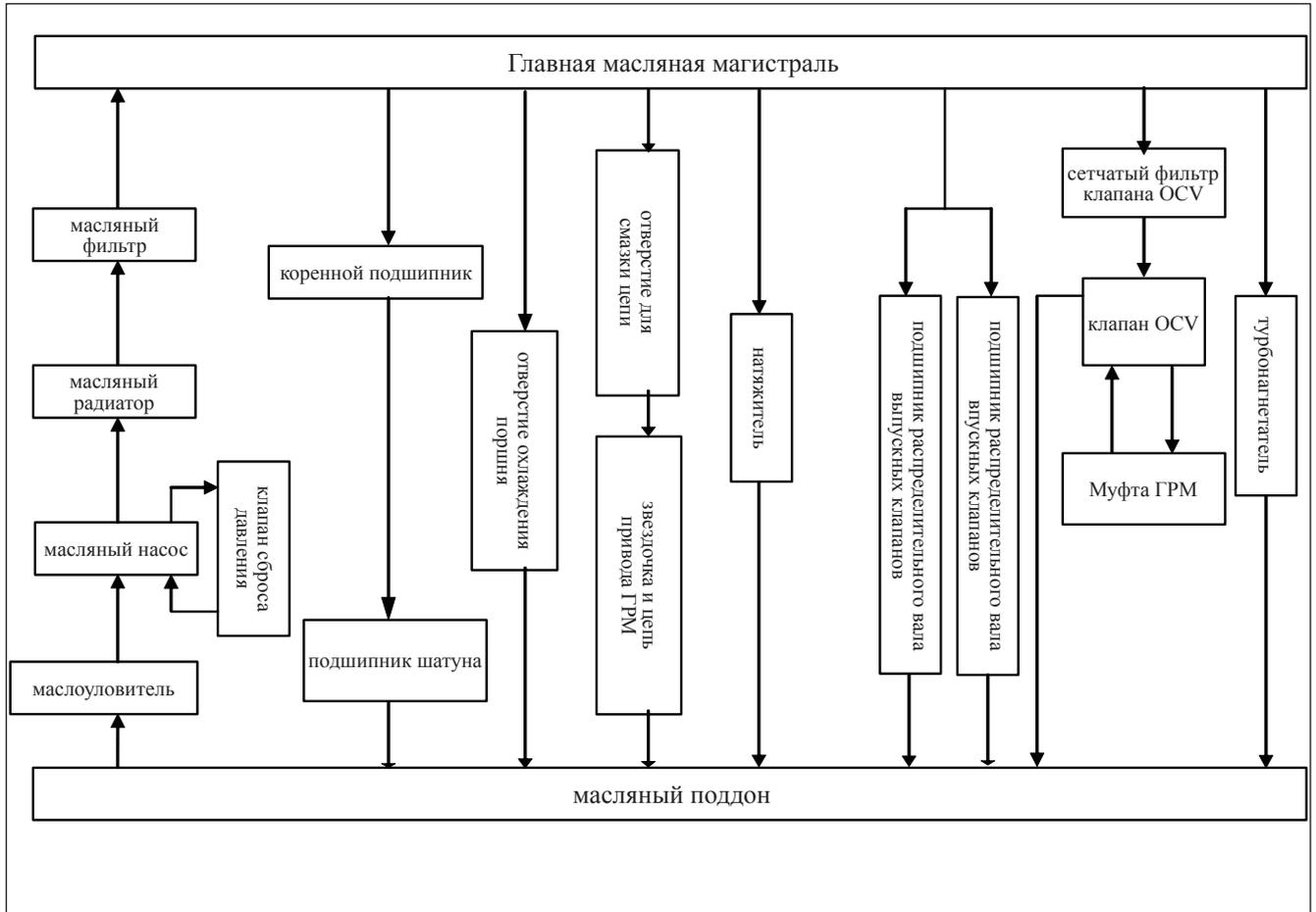
Рис. 11-1-2. Схема масляных магистралей системы смазки бензинового двигателя
