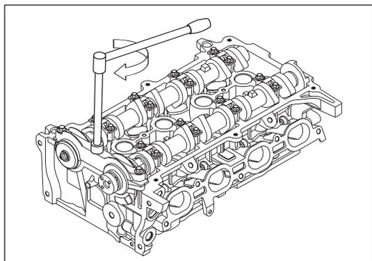
Рис. 12-3-46. Установка крышек подшипников распределительного вала с передней стороны
