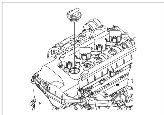
Рис. 12-2-9. Установка крышки заливной горловины
