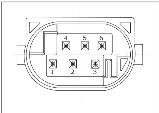
Рисунок 9-3-3. Схема подключения DVE-5
