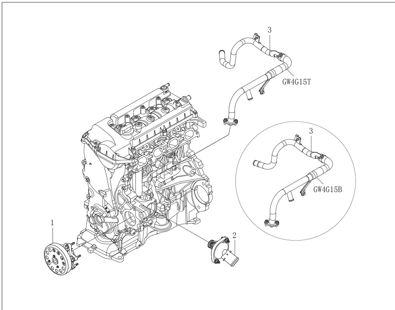
Рис. 10-1-1. Схема расположения компонентов системы охлаждения
