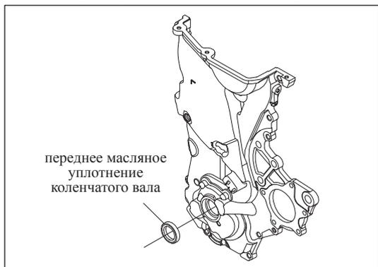
Рис. 11-4-8. Установка переднего масляного уплотнения коленчатого вала
