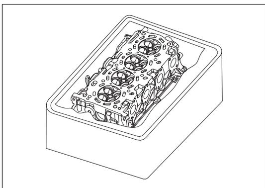
Рис. 12-3-9. Чистка головки блока цилиндров
