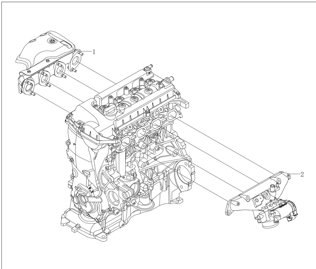
Рис. 8-1-1. Схема расположения компонентов системы подачи воздуха и системы выпуска отработавших газов
