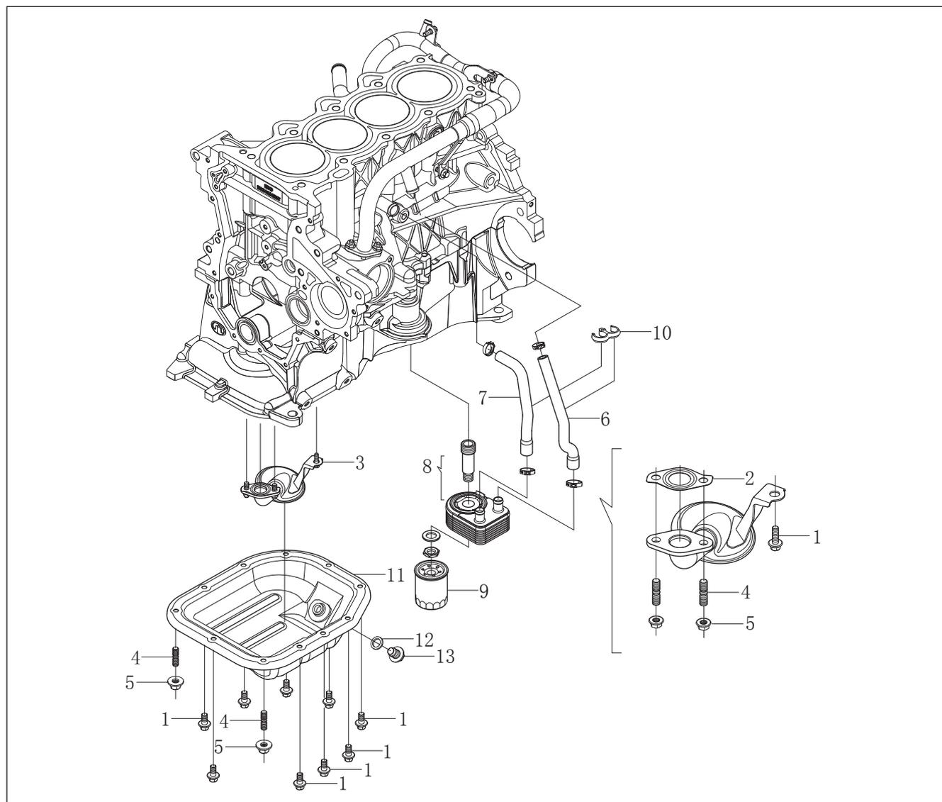
Рис. 11-3-1. Схема расположения компонентов маслоуловителя и поддона картера
