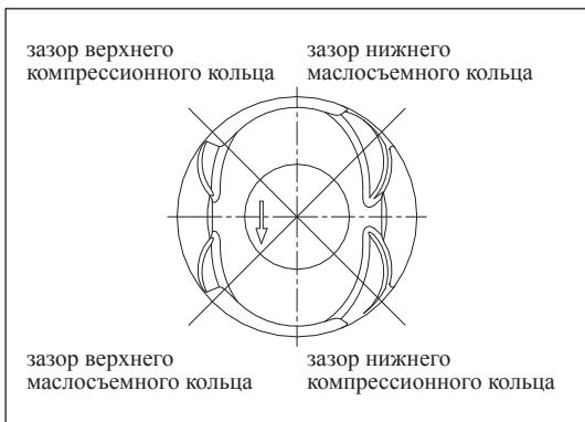
Рис. 13-2-11. Положение зазора поршневых колец
