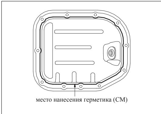
Рис. 11-3-7. Нанесение герметика
