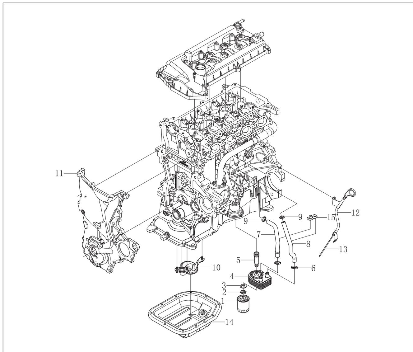
Рис. 11-1-1. Схема крепления компонентов системы смазки
