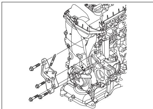
Рис. 6-4-1. Снятие передней опоры двигателя
