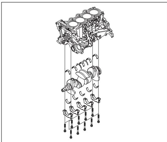
Рис. 13-3-18. Установка крышки коренного подшипника
